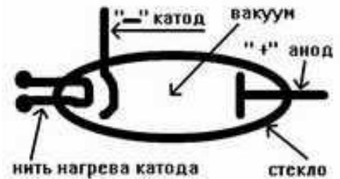
В ЭЛТ используется отклонение электронов электромагнитным полем и свечение люминофорных составов, которыми покрыты экраны трубок, при их бомбардировке электронами. ЭЛТ используются как кинескопы телевизоров, мониторов, осциллографов.
