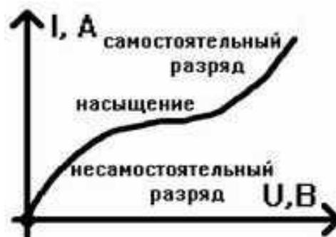
ионизации, называется несамостоятельным. Если разряд не прекращается после прекращения действия ионизатора, то он считается самостоятельным. Причиной возникновения самостоятельного разряда является ударная ионизация (электронная лавина) и эмиссия электронов при бомбардировке
