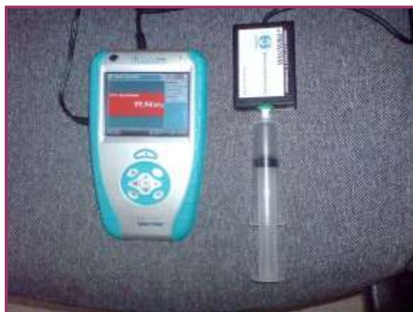
6. Плавно изменяя объем воздуха в шприце записывайте показания датчика давления в таблицу:
